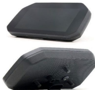
H3:: Vỏ bọc linh kiện hoàn thiện hai mặt in từ vật liệu Onyx gia cường sợi carbon thực tế
